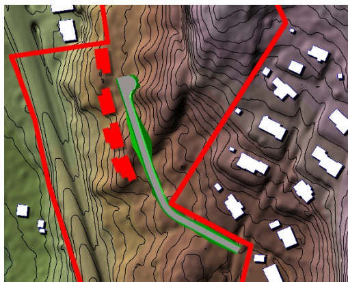
Kuva 15: Katu ja uudisrakennukset sovitettuna maastomalliin
