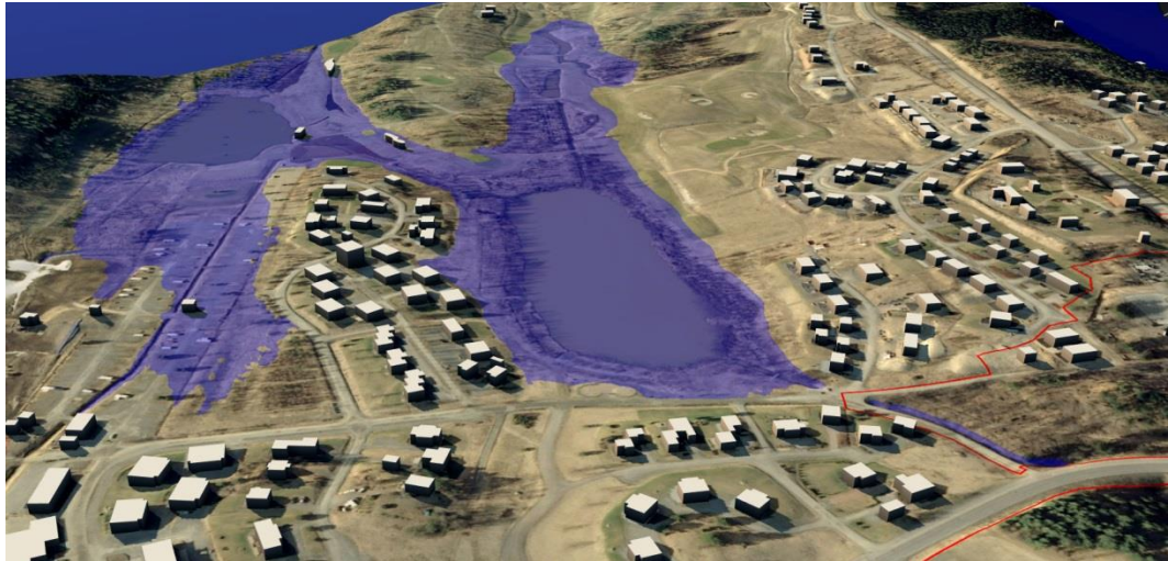
Kuva 58: Vedenkorkeus +82,45 havainnollistettuna maastomallissa
