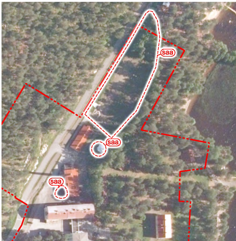
Kuva 5: Kohdat, joissa on havaittu pilaantuneita maita.
